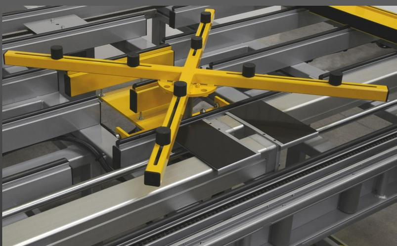
Croix centrale déplaçable en position avant avec bridage pneumatique automatique pour le vitrage des petits châssis
